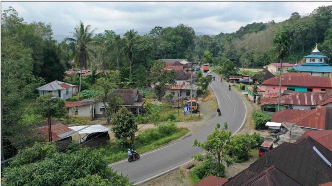
Gambar 14. Tata letak jalan khas di pedesaan Indonesia. Jalan berliku selebar ~ 6 hingga 7 m melayani lalu lintas lokal, regional, dan nasional. Kabel listrik udara dan telekomunikasi dengan tiang di kedua sisi jalan. Bangunan-bangunan berada dalam jarak yang dekat. Di dalam kota dan kota yang lebih besar, jalan pada umumnya sedikit lebih lebar, namun dengan lebih banyak kabel udara, tiang, dan papan reklame.
