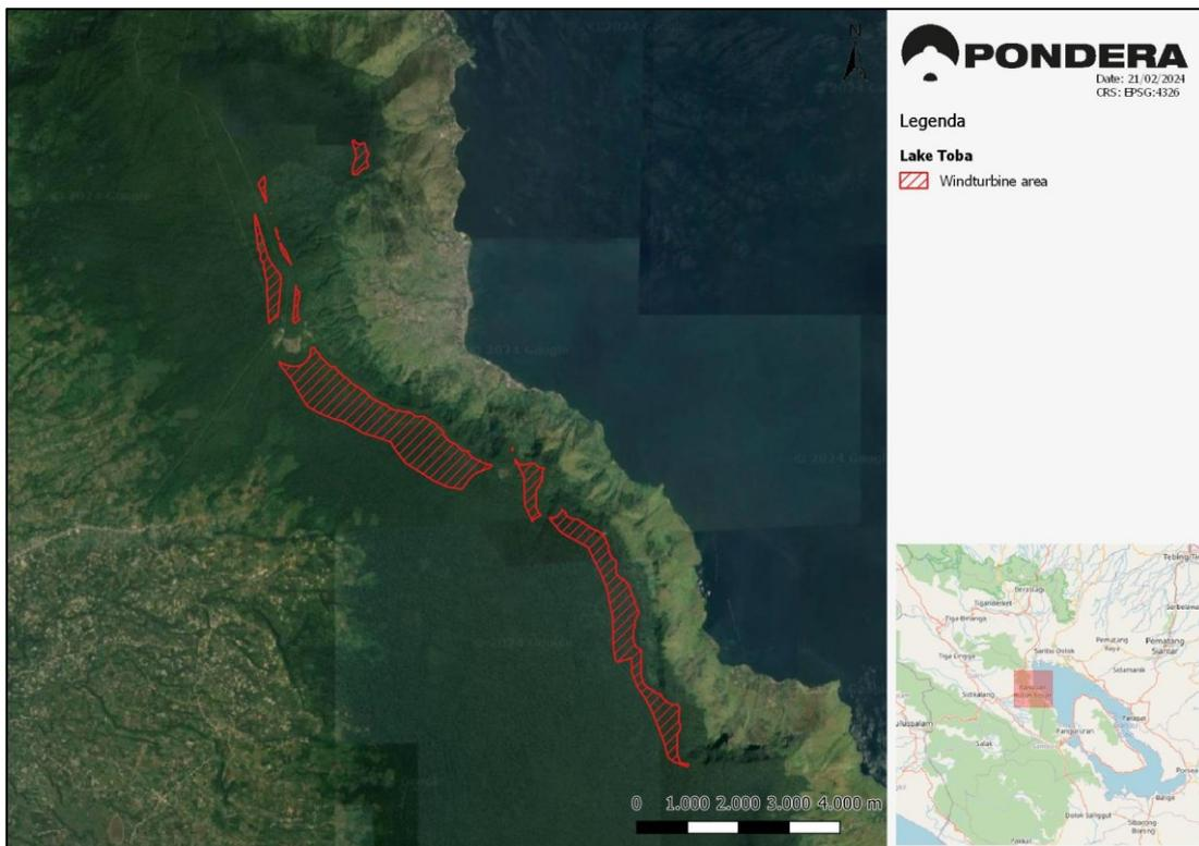
Gambar 12. Area WTG akhir berdasarkan kriteria pembatasan. Sumber: Google Satellite Images.
